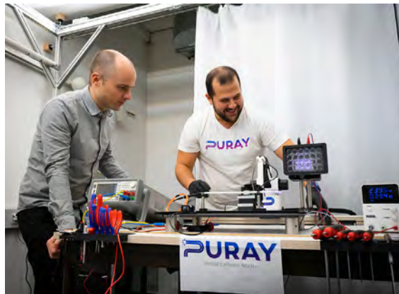
Martin Duffner und Eduardo Romero Borrero führen Intensitätsmessungen an einem Puray-Prototyp durch. © Hochschule München Hochschulkommunikation
